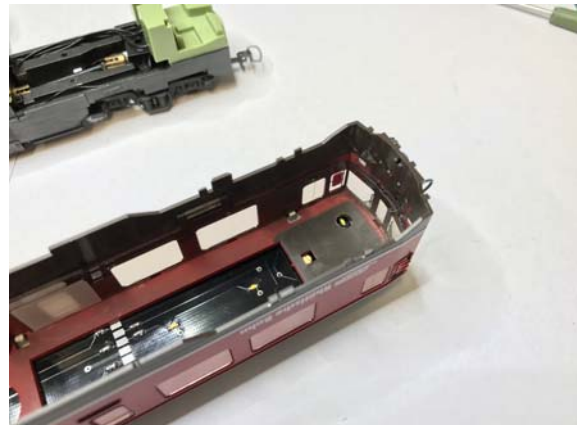
8 Abbildung der gebohrten Führerstandbeleuchtung.
