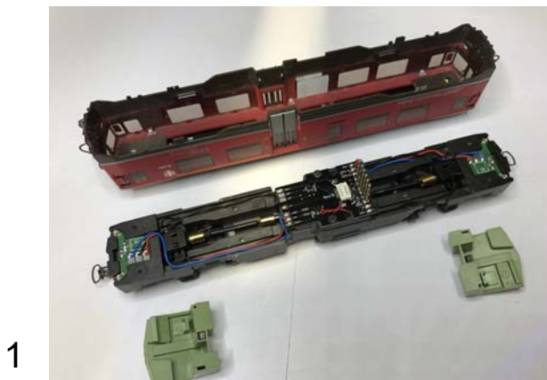
9 Innenbeleuchtungs-Platine am Dach-Teil anschrauben und Gehäuse aufsetzen.
