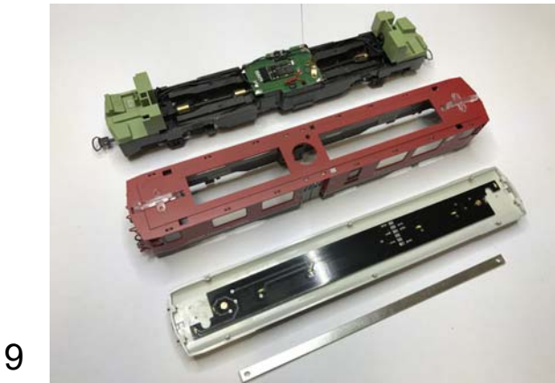
7 Lichtleit-Teil herausnehmen und bohren. Je, grösser, desto besser. Empfehlung: 4.5mm Bohrer.
