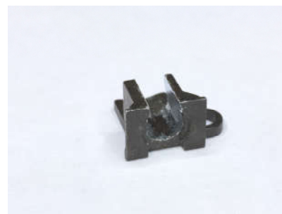
Lampenaufnahme: Es müssen so aussehen. Schlitzbreite ca. 2.5 – 3mm.
