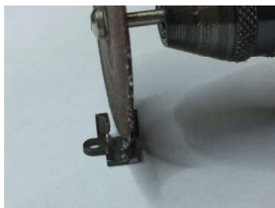
Lampenaufnahme: Mit Trennscheibe trennen.
