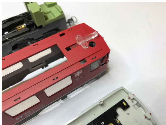
Abbildung der gebohrten Führerstandbeleuchtung.
