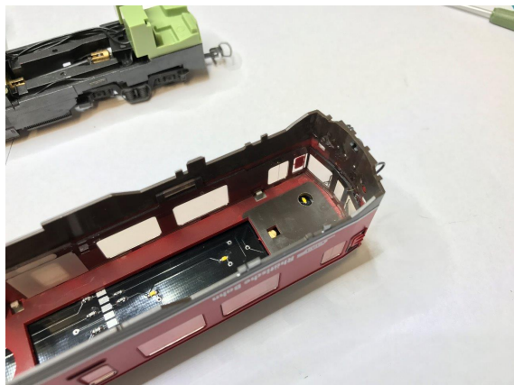
LED muss durch die Bohrung im Führerstand sichtbar sein.
