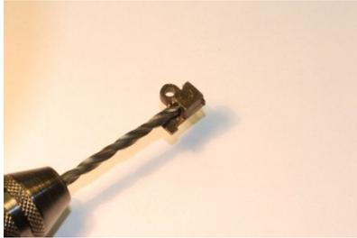
2x Platine aus Lokrahmen herausnehmen (Glühbirne entfernen), mit 3.5mm Bohrer aufbohren.
