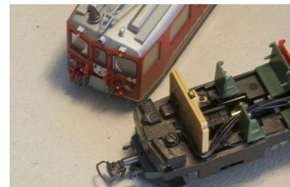
Wenn alles i.O. ist LED-Leiterplatte montieren und nochmals testen, dann Gehäuse aufsetzen.
