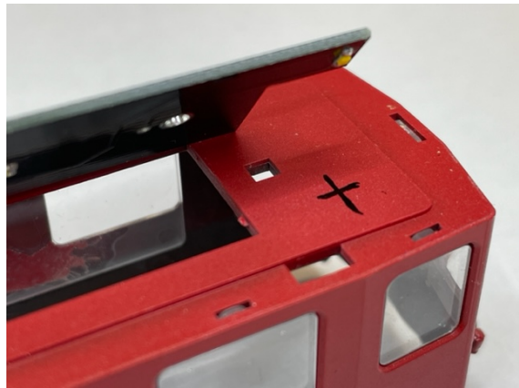
Und mit Filzstift Position für Führerstandbeleuchtung markieren.
