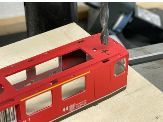
Bohren. Je, grösser, desto besser. Empfehlung: 4.5mm Bohrer.
