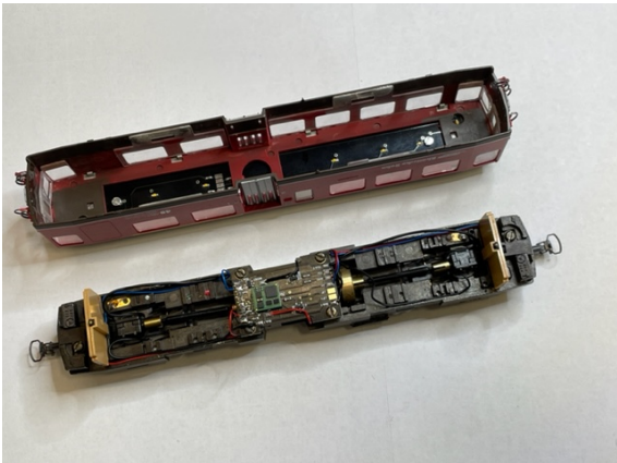
Alte Platine für Lokdecoder gegen neue Multifunktions-Platine austauschen
